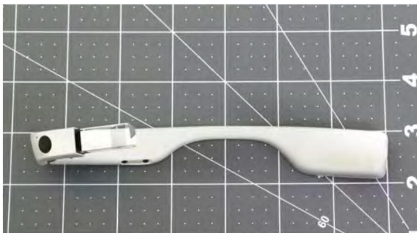
而去年 12 月的一份新的 FCC 文件表明这个企业版 GoogleGlass 将可以折叠，将有更耐用的设计，棱镜显示器面积比第一代 GoogleGlass 更大。测试照片还透露了磁性电池接口，以及一个英特尔 Atom 处理器芯片。
